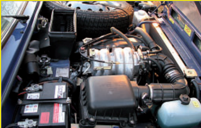
Nivan moottoritila on suhteellisen väljä ja kaikki huoltokohteet on hyvin käsillä, jopa vararengaskin mahtuu sinne.
