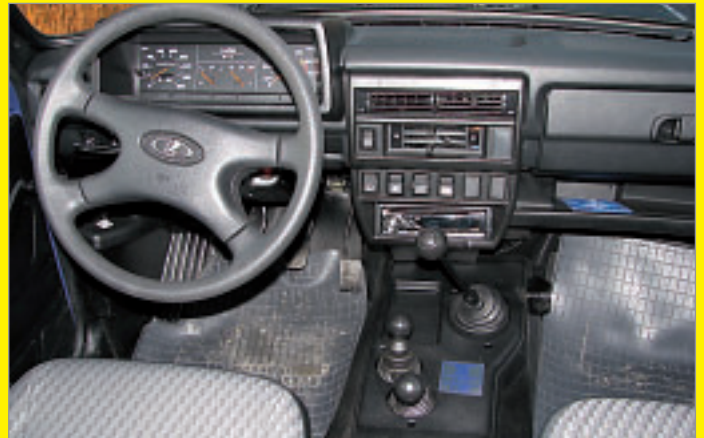
Nivan kojetaulu on perinteisen selkeä ja katkaisijoita on helppo käyttää vaikka hanskat kädessä. Lämmityslaitteessa voi säädellä lämmintä ja kylmää ilmaa erikseen. Keskitunnelin päällä on kolme keppiä, joista pisin on vaihdekeppi ja lyhyemmät ovat alennusvaihteiston sekä keskitasauspyörästön käyttövivut.
