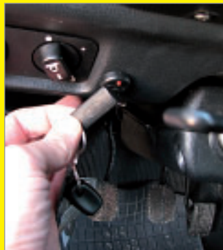
Käynnistykseneston kuittaus ja virtalukko ovat Ladan tyyliin ohjauspylvään vasemmalla puolella.
