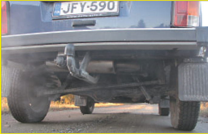
Maavara 22 cm, kapeat, korkeat ja karkeakuivoiset renkaat sekä joustava alusta tekevät Nivasta maastokelpoisen.
